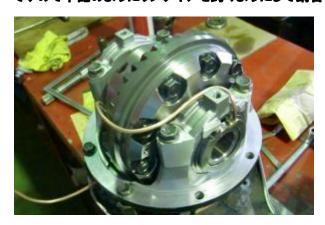
③ ファームロッカー FL-02(JA・JB前期8穴ボルト)をインストール時、説明書ではJB系へのインストール時、3mmのリングギアスペーサーを取り付けると記載していますが、この度の仕様変更によってJA系へインストール時にリングギアスペーサーを使用して下さい。
