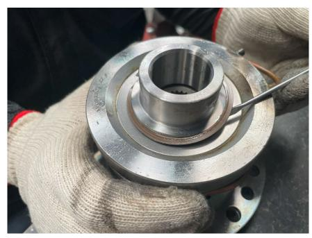
□エアロッカーのクラッチ、クラッチピンを外します。
