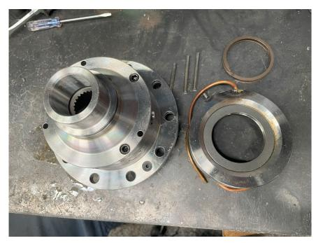
□リングギアボルトにネジロック剤を付けて、サービスマニュアル等を参考に規定トルクで規定 通りの順番でボルトを締め付けて下さい。
