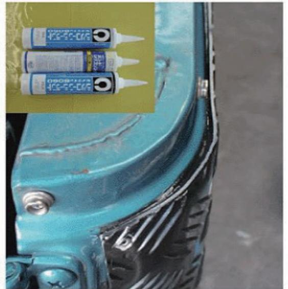
5. 隙間が開いている部分にシール材④を塗布します。シール材④は、画像にありますように、いろいろな色がありますので、車体に近い色、あるいは商品に近い色を選択することにより、隙間が目立たなくなります。
