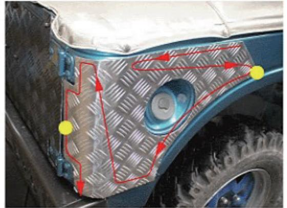
4. 電動ドリル①を用いて車体に穴を開け、その都度、開けた穴にビスをドライバー②で捻じ込んでいきます。穴は、上の写真のように、端から順番に開けていきます。※逆の順番でもOKです。
