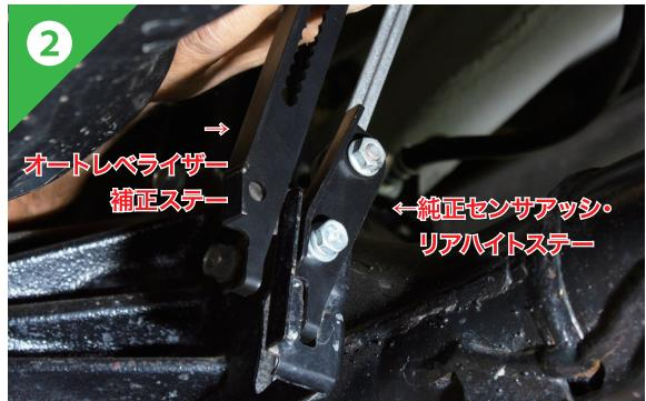
ハイセンサーのロッド部分及びデフ玉部分に固定されたボルトとナットを外し、純正のセンサーアッシ・リアハイストレーとオートレベルライザーブラケットを交換します。ステー下側のツメをデフ玉部分の穴に差し込み、ボルトとナットで留めます。ハイセンサーのロッド部分のボルトとナットは、リフトUP量に応じて取付位置が異なります。2インチUPの場合は、純正位置より約45mmロングの位置に、3インチUPの場合は、純正位置より約60mmロングの位置に取り付けます。
