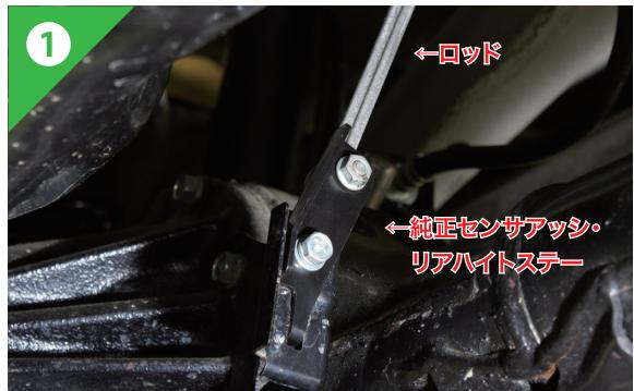
車体リア側の正規のジャッキアップポイントをジャッキで上げ、アクスルハウジングのデフ玉上のハイセンサーを確認します。レベルライザーブラケットの為に交換する部品は、純正のセンサーアッシ・リアハイストレーです。その他のハイセンサーのセンサー及びロッド部分は純正状態のまま使用しますので、動かさないと作業できない場合は純正状態に戻せるようにマスキングテープ等で印を付けて下さい。
