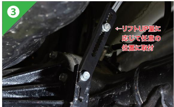
車両状況を確認し、取付ボルトの微調整を行います。オートレベルライザーブラケットは無段階調整の為、任意の場所に取付可能です。点灯確認をし、光軸のズレがあれば再度微調整を行います。問題がなければ以上で作業完了です。
