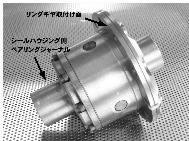
□リングギヤが付く側のベアリングキャップに純正のアジャスターを軽く手で締まるまで組み付ける
