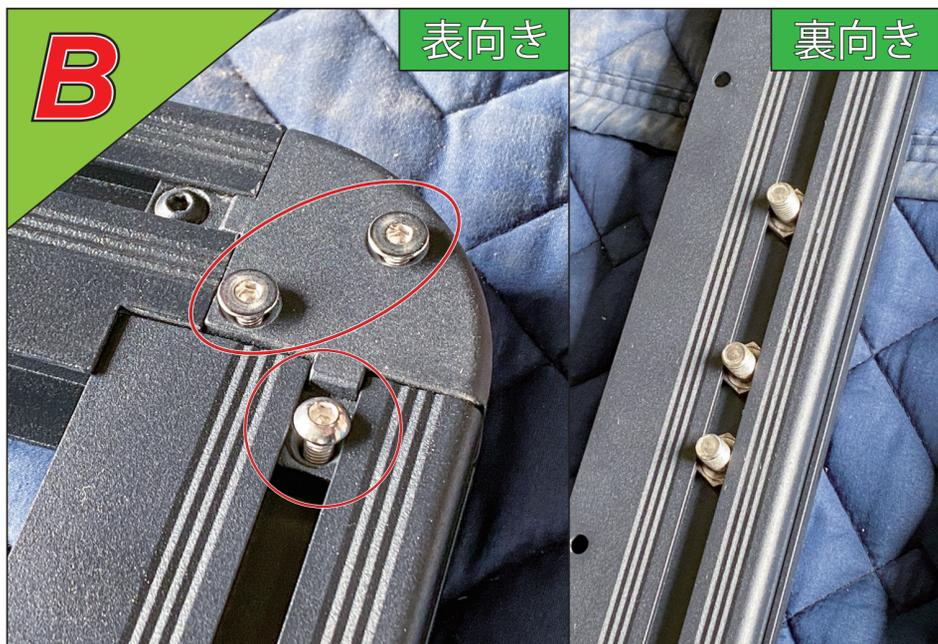
①フレームのコーナーと②フレームをはめ込み、**A**で外したコーナー用の六角穴付きボルトを使用して固定し、コーナーの緩んでいる六角穴付きボルトを外れない程度に仮締めをします(4箇所)
