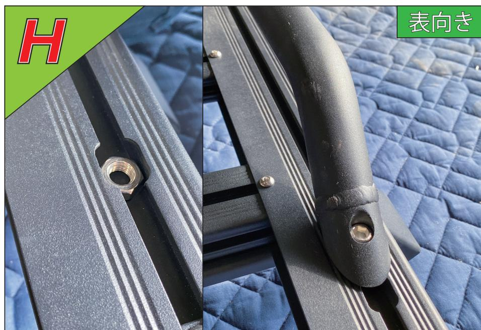
ルーフキャリアを表向きにして②フレーム表側のスリットから⑭ナットを2個入れて⑮六角穴付きボルトを使用し、④サイドバーを固定します(2箇所)
