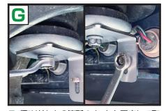
Eで取り外した2箇所のナットを固定して取り付け完了です
