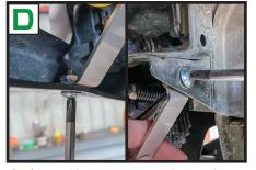
③ボルトを使用してステー下部の固定をします また、Aで仮止めをしたステー上部も固定 して取り付け完了です
