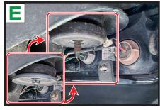
リアのマウンティングプレート止めている ナットを外してプレートを取り外します また、バンパー裏のテールランプを固定し ているナットも取り外します
