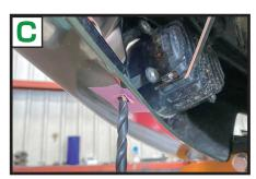
Aで仮止めしたステーを横にずらして、Bで付けた印をもとに、穴が6mmになるように徐々にドリルビットを変えながら穴をあけます (※)
