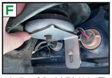
マウンティングプレートを裏向きにして戻して、④⑤ステーをプレートの下に配置します
