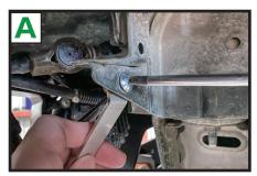
「製品の形状について」を参考にして①② ステー上部を持ち、写真の通りフレームに ③ボルトを使用して仮止めします
