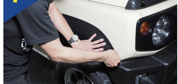
表面に出した剥離紙を引っ張りながら、製品を車体に押し
