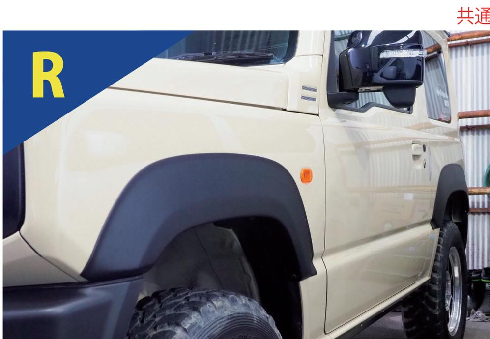
両面テープの剥がれ防止の為、製品と車体間の接着剤が馴染むまで24時間ほど安静にします。
