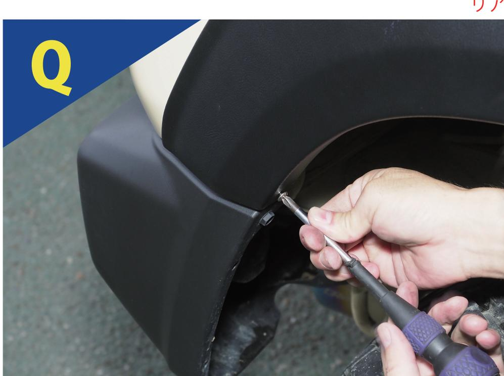
穴あけ加工後、付属のビスで車体後方と製品を留めます。
