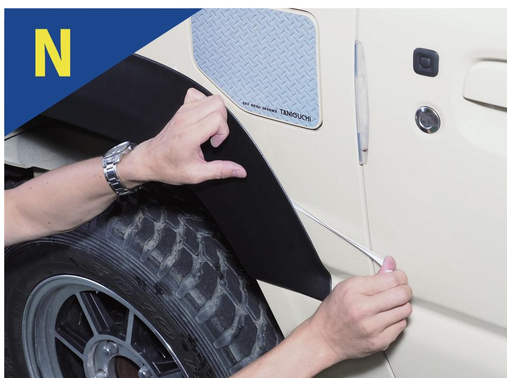
仮留めした後、行程Kと同様に表面に出した剥離紙を引っ張りながら、製品を車体に押し当てて接着して下さい。
