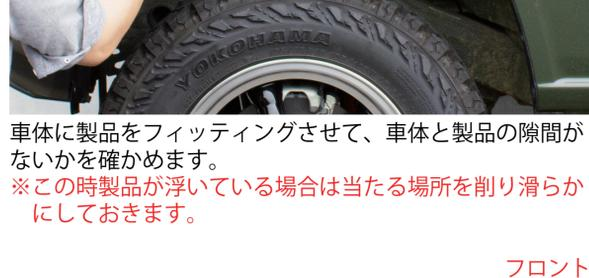
車体に製品をフィッティングさせて、車体と製品の隙間が
