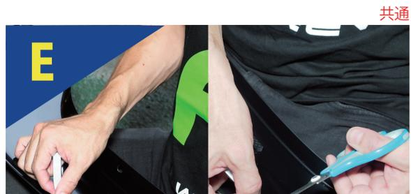
製品裏面の脱脂後、両面テープを貼り付けていきます。
