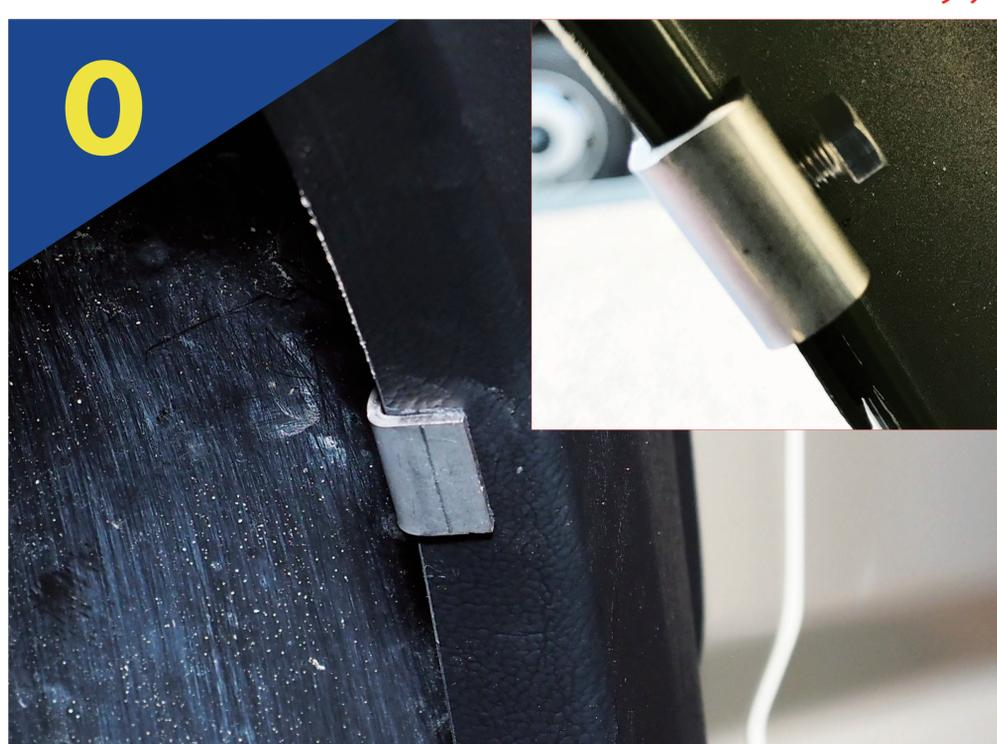
製品接着後、付属のU字金具とボルトで、リアフェンダーの前方と車体を留めます。
