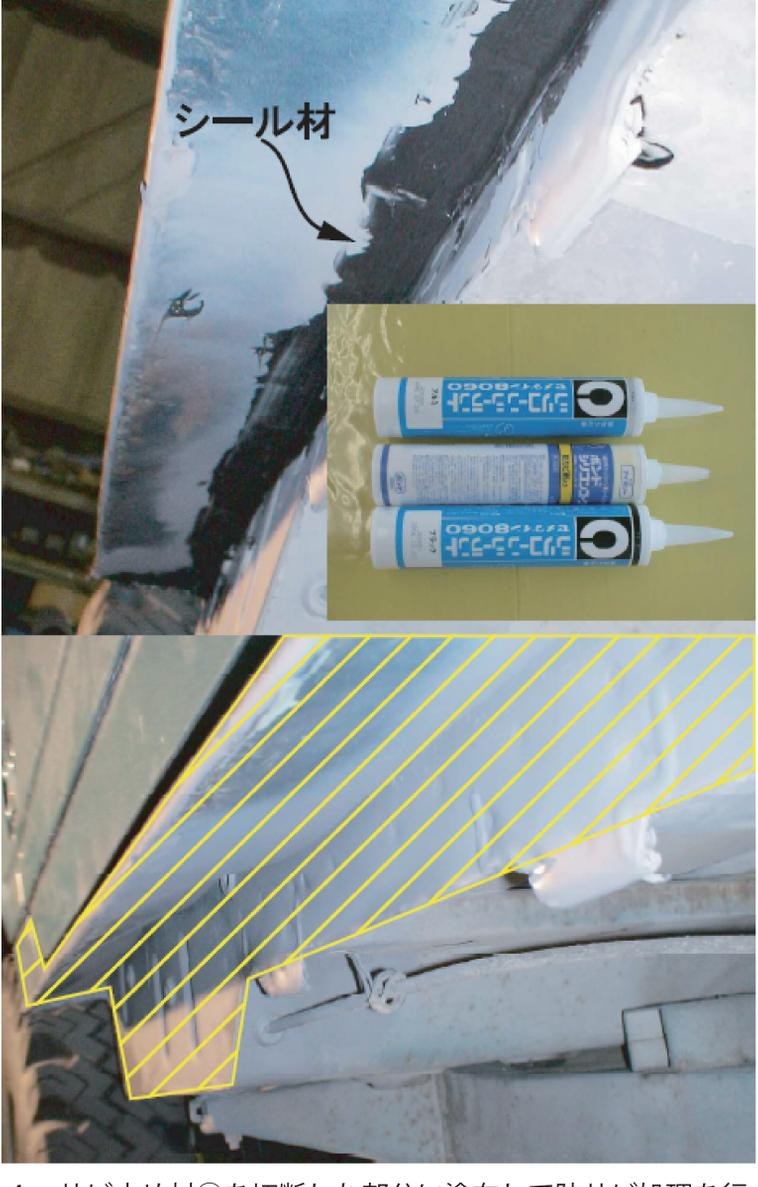
4. サビ止め材⑤を切断した部分に塗布して防サビ処理を行
