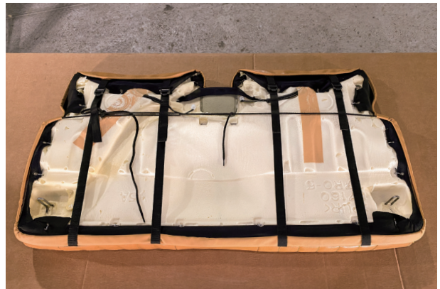
10 ベルトとひもを固定した後の写真です カバーにたるみやシワがある場合はカバーをシートに馴染ませた後に、もう一度固定し直して下さい
