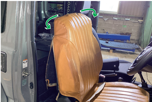
1 カバー背面のファスナーを開け、シート全体にカバーを被せます
