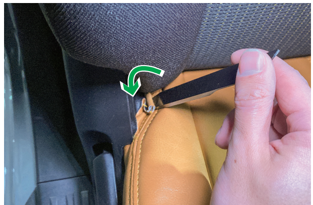
6 カバー両側付け根の小さい生地を、シートの軸部分の隙間に入れ込みます
