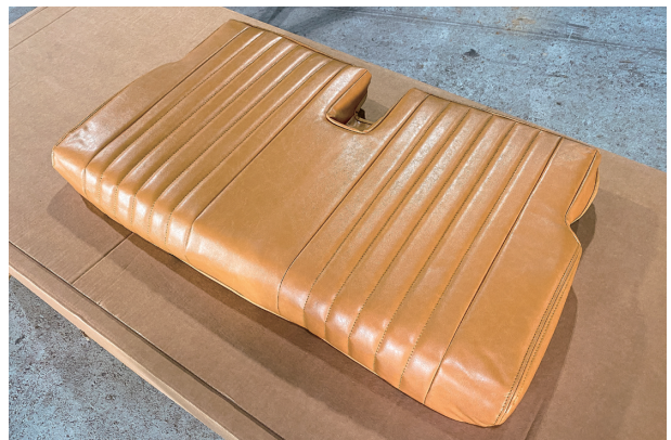
12 カバーのラインを整えて、2列目座面の完成です ※シートは背もたれのカバー装着完了後に車体へ戻します
