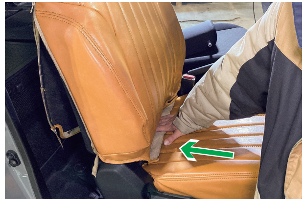
2 背もたれと座面の隙間に生地を入れ込みます
