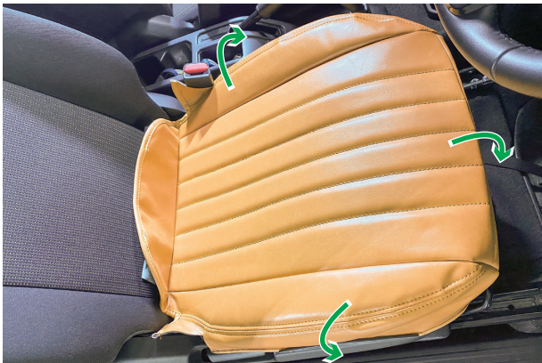
1 シートのラインに合わせてカバーを被せます
