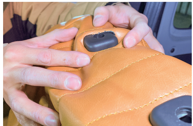
4 カバー上部の加工穴からヘッドレストの台座を取り出します ※強く引張って台座に隠れない程の裂け目が入らないようご注意ください
