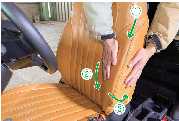
5 カバーをシートに馴染ませます 写真のように、①～③の手順で、カバーの上から下に向かってシワを寄せ、寄せた生地を3番と同様に背面から引き出します
