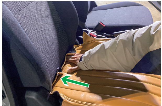
2 背もたれと座面の隙間に生地を入れ込みます ※背もたれの角度を調節して、入れ込みやすい角度で作業して下さい
