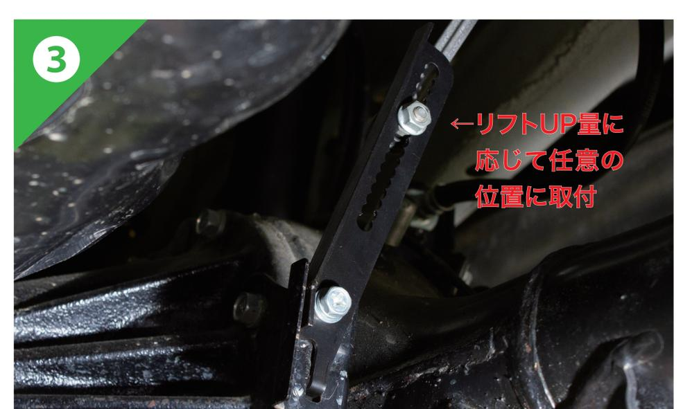
車両状況を確認し、取付ボルトの調整を行います。オートレベライザー補正ステーは無段階調整のため、任意の場所に取り付け可能です。
