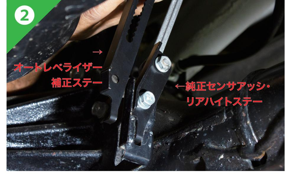
ハイトセンサーのロッド部分及びデフ玉部分に固定されたボルトとナットを外し、純正のセンサアシ、リアハイトのステーとオートレベライザー補正ステーを交換します。
