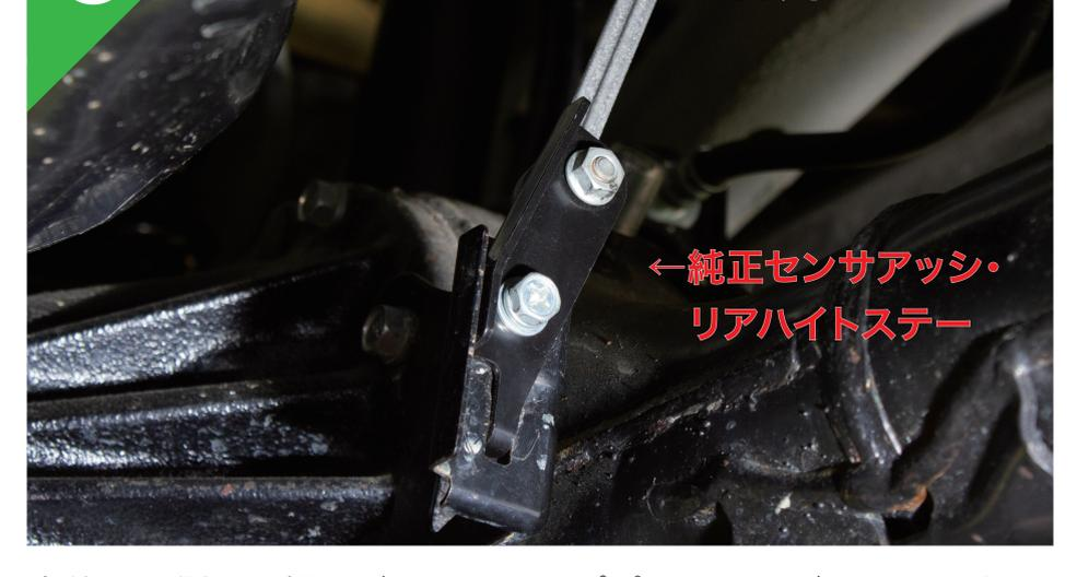
車体リア側の正規のジャッキアップポイントをジャッキで上げ、アクスルハウジングのデフ玉上のハイトセンサーを確認します。
