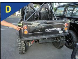
D 配線の取り回しが完了したらテールランプの端子にギボシを取付けて、テールランプ本体を車両に取り付けハーネスと接続する。
