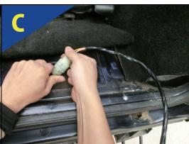
C 左右のカプラーホルダーにキットのカプラーホルダーを取り付け、丸いアース端子をボディーにビス止めする。
